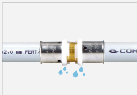
FITTING NOT PRESSED AND TESTED BETWEEN 1 AND 4,5 BAR - IT LEAKS / RACCORDO NON PRESSATO PROVATO DA 1 FINO A 4,5 BAR - PERDE
